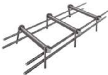
Dovelas de Transferencia y Canastillas
